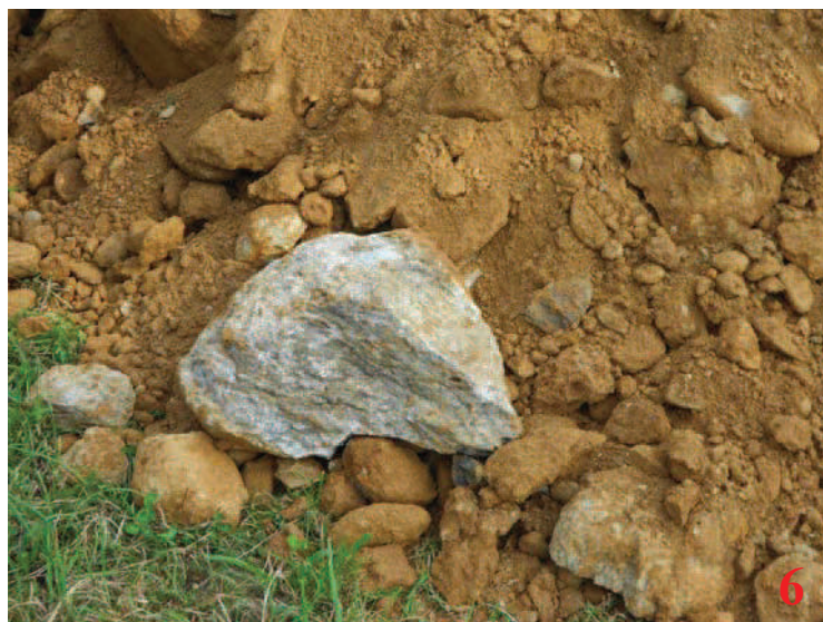
Foto n. 4-5-6 da m 3.10 a m 5.10 : ghiaie anche con blocchi in matrice sabbioso-limosa alterata in colore rossastro.
